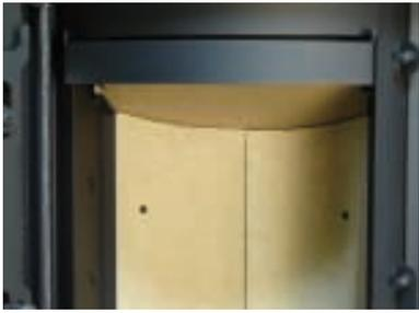
La chamotte isole la chambre de combustion et permet d'atteindre de très hautes performances énergétiques et environnementales. La chamotte est très résistante mécaniquement. Les 2 trous apparents sont des injecteurs d'air tertiaire qui permettent une double-combustion très efficace. Le coupe-flamme (en haut) est aussi en chamotte.
