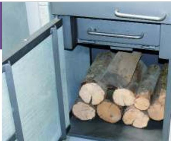
L'air primaire et l'air secondaire sont réglables séparément et cachés derrière la porte de bûcher. Un grand cendrier de type tiroir et le dégrilleur limitent les interventions de décrochage (photo Pylos 184).
